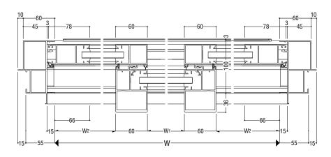
製作制限 ※障子 1 枚の重量が85kg以下の場合はZAB、85kgを超える場合はZBタイプとなります。 ※FIX部W寸法が障子W寸法を超える場合、当社営業窓口までご相談ください。
