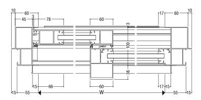
■製作制限 ※障子 1 枚の重量が85kg以下の場合はZAB、85kgを超える場合はZBタイプとなります。 ※ FIX 部W 寸法が障子W 寸法を超える場合、当社営業窓口までご相談ください。
